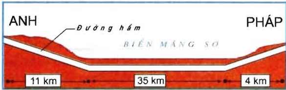
Hình 7.8. Sơ đồ đường hầm giao thông dưới biển Măng-sơ.
