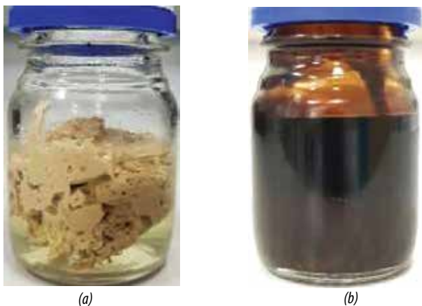
Hình 3. Thí nghiệm sự tương thích của hóa phẩm EN với nước và dầu (a) và dầu (b).
