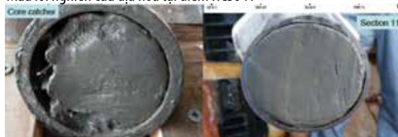
Hình 5. Một số hình ảnh mẫu trầm tích nông thu thập cho phân tích địa hóa, thạch học Lỗ 148 - 149 [6].
