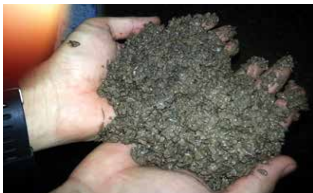
Hình 4. Mùn khoan trước khi làm sạch
