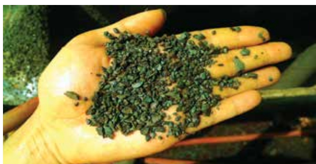
Hình 5. Mùn khoan sau khi làm sạch
