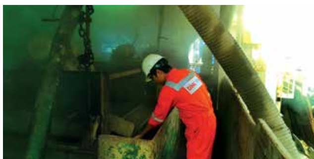
Hình 6. Kỹ sư DMC-WS kiểm tra tình trạng mùn khoan
