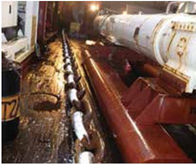
Hình 15. Kiểm soát xoắn xích trên tàu
