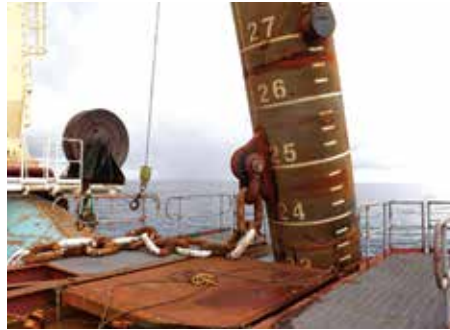
Hình 16. Nối đoạn xích cuối vào cọc
