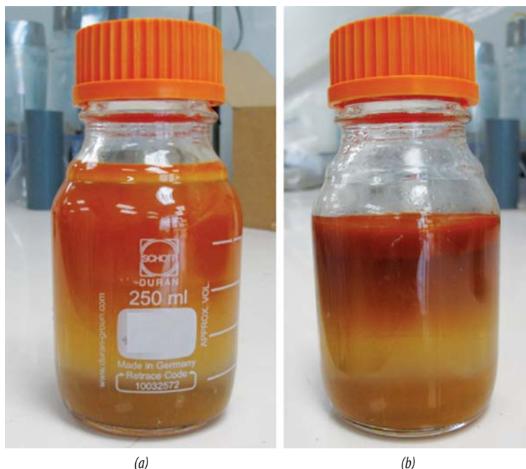
Hình 8. Hình ảnh dung dịch thử nghiệm sau khi thử nghiệm đánh giá ăn mòn trong pha lỏng tại các điều kiện N9 (a) và N12 (b)
