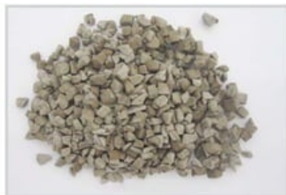
Hình 3. Mùn khoan thu hồi từ hệ dung dịch khoan MEGADRIL
