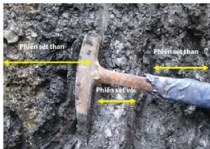
Hình 4. Đá phiến sét than xen kẽ lớp mỏng phiến sét vôi [21]
