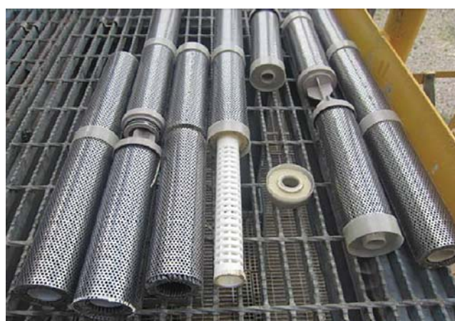
Điểm nối giữa các phần của lõi lọc bị rời ra do keo kết dính bị biến chất sau 40 ngày hoạt động
