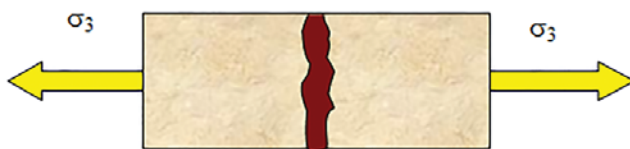
Hình 6. Mô tả phá hủy kéo (Tensile failure) [12]
