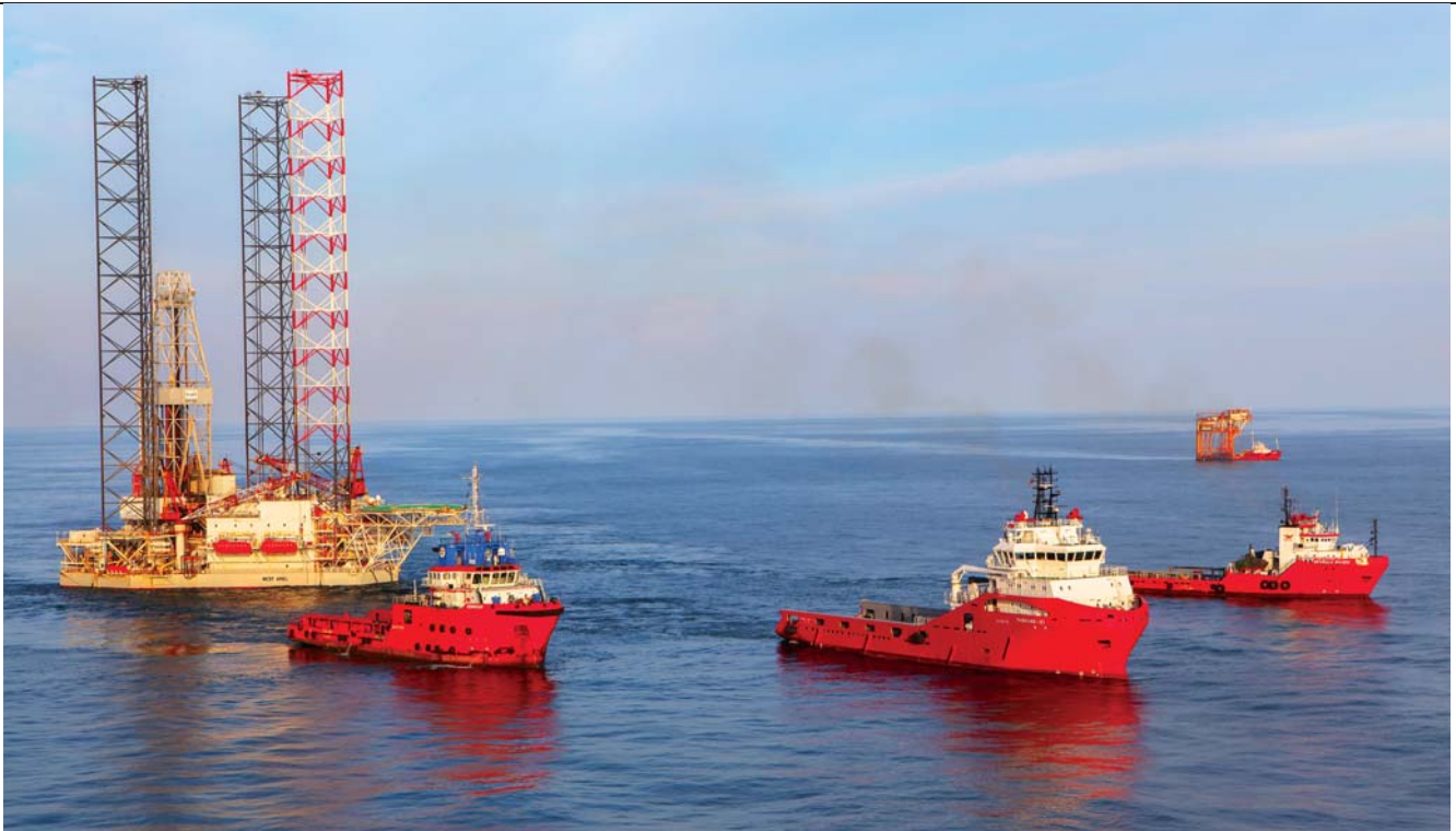
Đội tàu dịch vụ đưa tàu khoan di động West Ariel vào vị trí mới thuộc mỏ Bạch Hổ, Liên doanh Việt - Nga "Vietsovpetro". Ảnh: Minh Trí
