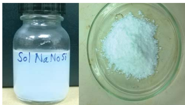
Hình 5. Mẫu nanosilica: (a) dung dịch keo nanosilica, (b) hạt nanosilica
