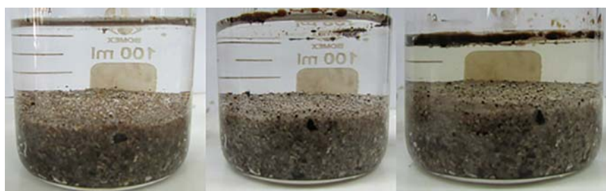
Hình 14. Khảo sát khả năng tự đẩy dầu của dung dịch chất hoạt động bề mặt theo thời gian
