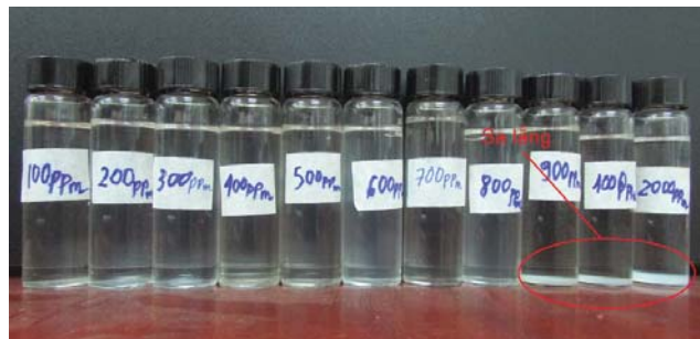
Hình 6. Khả năng phân tán của hạt nanosilica trong hệ chất hoạt động bề mặt sau 14 ngày
