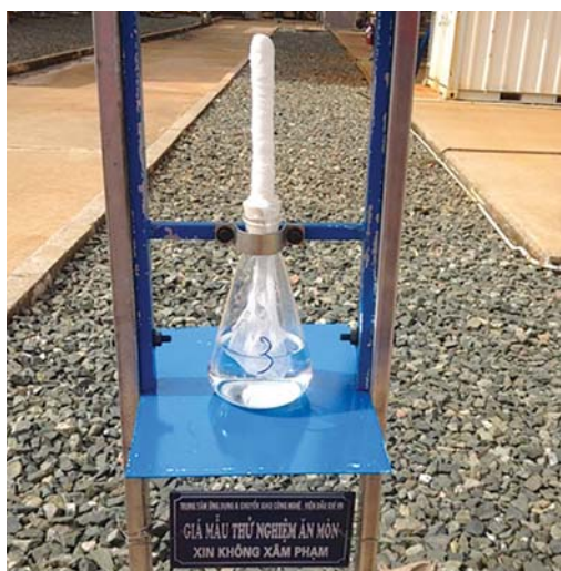
Hình 2. Dụng cụ xác định hàm lượng muối trong không khí theo Tiêu chuẩn ASTM G140
