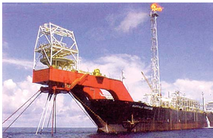
Hình 1. FPSO dạng neo một điểm neo
