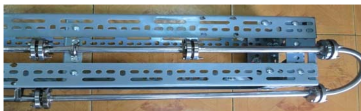
Hình 5. Thiết bị static mixer gồm các module nối tiếp nhau
