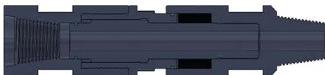
Hình 5. Cấu tạo cơ bản của thiết bị giảm sốc
