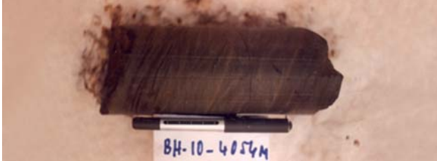
Hình 2. Cát kết hạt mịn đến trung bão hòa dầu, sàng lọc tốt, phân lớp xiên tương đối cát sông tuổi Oligocen dưới
