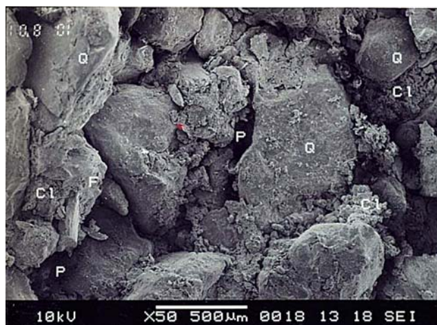
Hình 9. Cát kết hạt trung - thô, chọn lọc kém. Không gian rỗng bị lấp bởi khoáng vật thứ sinh nhưng còn giữ được liên thông tốt (giếng ST-3X)
