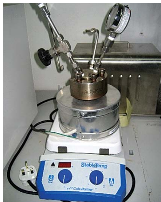
Hình 1. Sơ đồ thiết bị cao áp tổng hợp biodiesel
