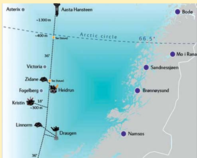
Đường ống dẫn khí đốt ngầm dưới biển sâu dài nhất thế giới 482km nối mỏ Aasta Hansteen với Nyhamna. Ảnh: Statoil
