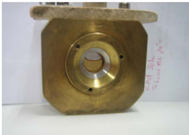
Hình 3. Cấu tạo của cell phản ứng kết tinh thủy nhiệt sử dụng để đo XRD/XAS trong dòng tại Phòng thí nghiệm BM26 SRS Lab - Grenoble, Pháp
