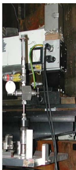
Hình 5. Thiết bị đo phổ tán sắc năng lượng tia X EDXRD trong dòng
