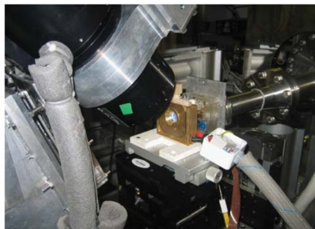
Hình 4. Thiết lập thí nghiệm đo phổ hấp thụ in-situ XRD/XAS tại phòng thí nghiệm BM26 SRS Lab - Grenoble, Pháp: vị trí Detector (trái) và bộ điều khiển nhiệt độ (phải)
