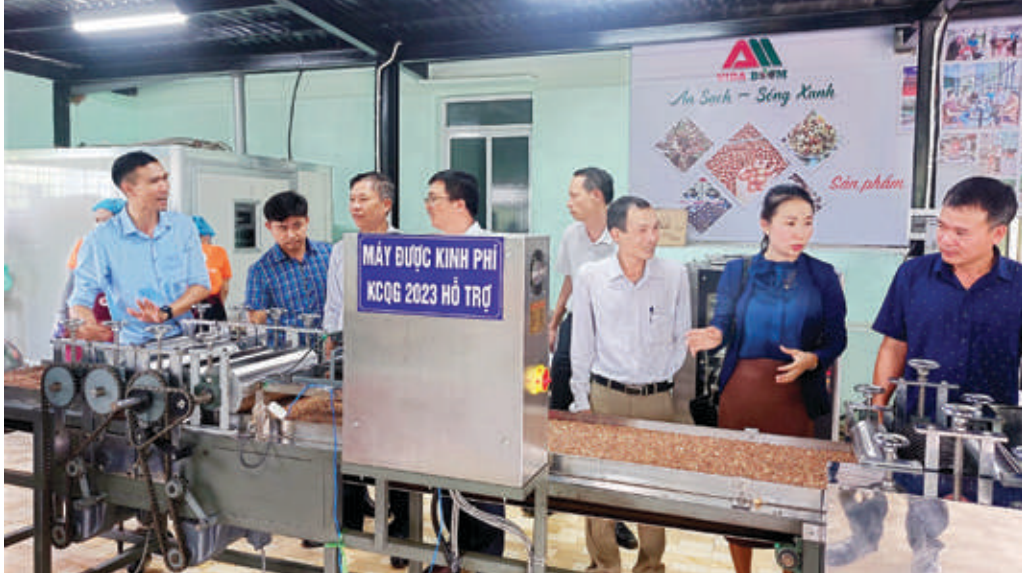
Từ nguồn kinh phí khuyến công quốc gia hỗ trợ 300 triệu đồng Công ty TNHH một thành viên TM & DV An Phát đã đầu tư 01 máy cán, cắt kẹo tự động cho năng suất 80kg/giờ
