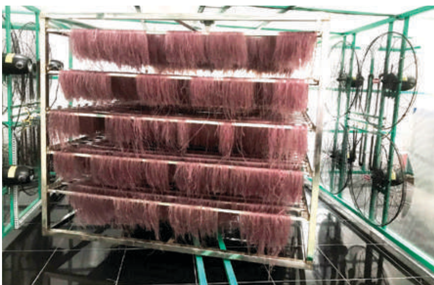
Máy sấy bún, hủ tiếu, bánh tráng tại Cơ sở Sản xuất thực phẩm Huỳnh Đức sử dụng năng lượng mặt trời
