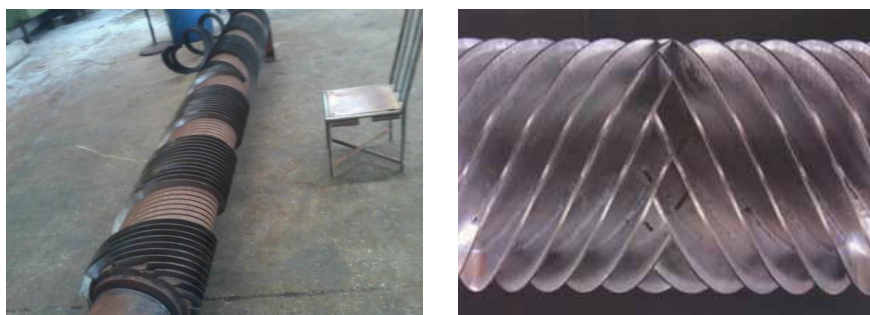
Hình 5.5. Dao và trục dao của máy nạo mỡ
