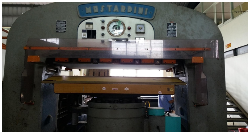
Hình 5.29. Máy in là sử dụng tấm lak in da Mostardini (Ý)
