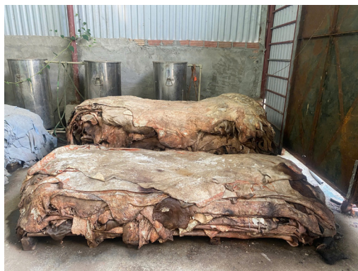
Hình 1.12. Bảo quản da động vật bằng muối hạt
