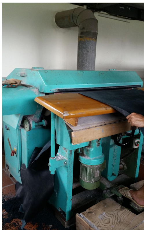
Hình 5.24. Máy đánh mặt gián đoạn Aletti (Ý)
