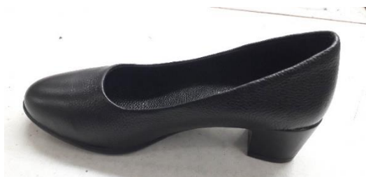
Hình 3.44. Mẫu giày chế thử hoàn chỉnh
