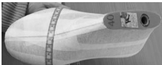
Hình 3.48. Cắt bỏ phần dư và xẻ đôi áo phom
