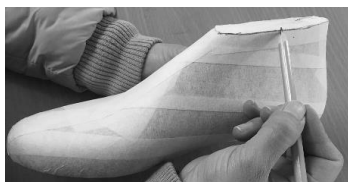
Hình 3.47. Xác định gờ đáy phom và gu phom
