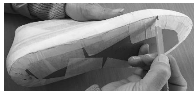
Hình 3.47. Xác định gờ đáy phom và gu phom
