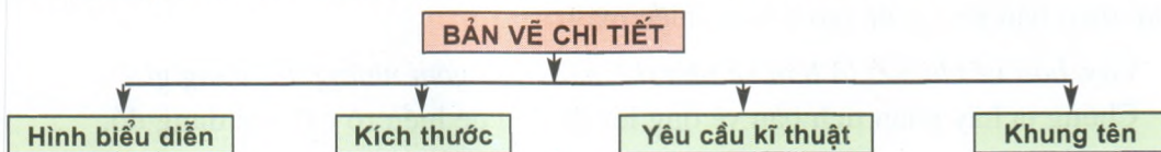
Hình 9.2. Sơ đồ nội dung bản vẽ chi tiết
