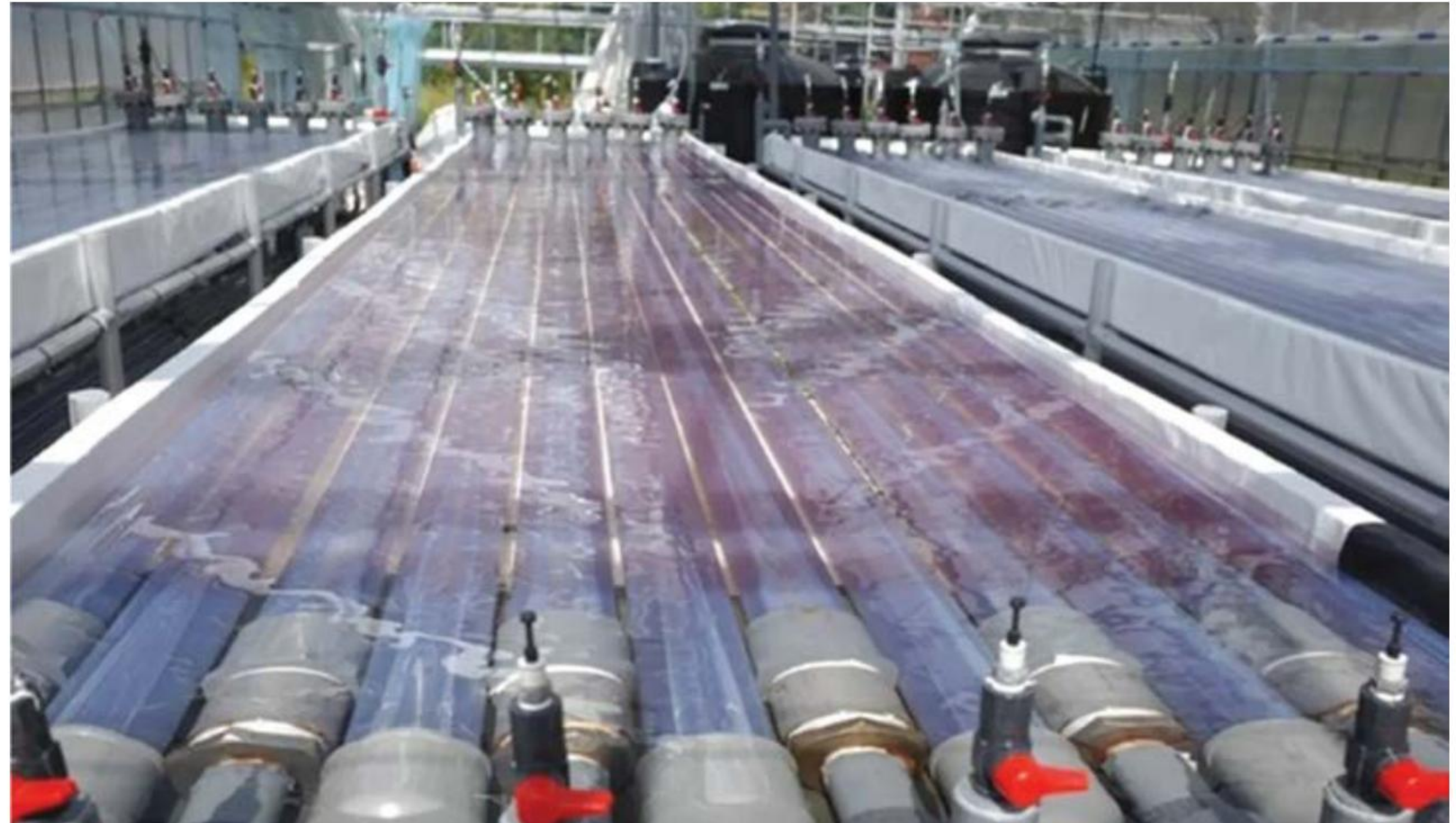
Vi khuẩn tia do Công ty Symbiobe sản xuất được nuôi cấy từ nitơ trong khí quyển, carbon dioxide và ánh sáng mặt trời
