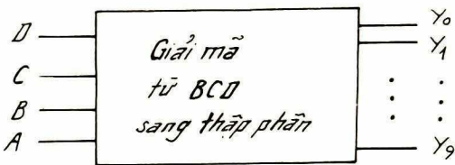
Hình 4-3-5. Sơ đồ khối mạch yêu cầu.
