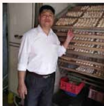
Chiếc máy ấp này có công suất 6.000 trứng với tính năng đảo tự động.
