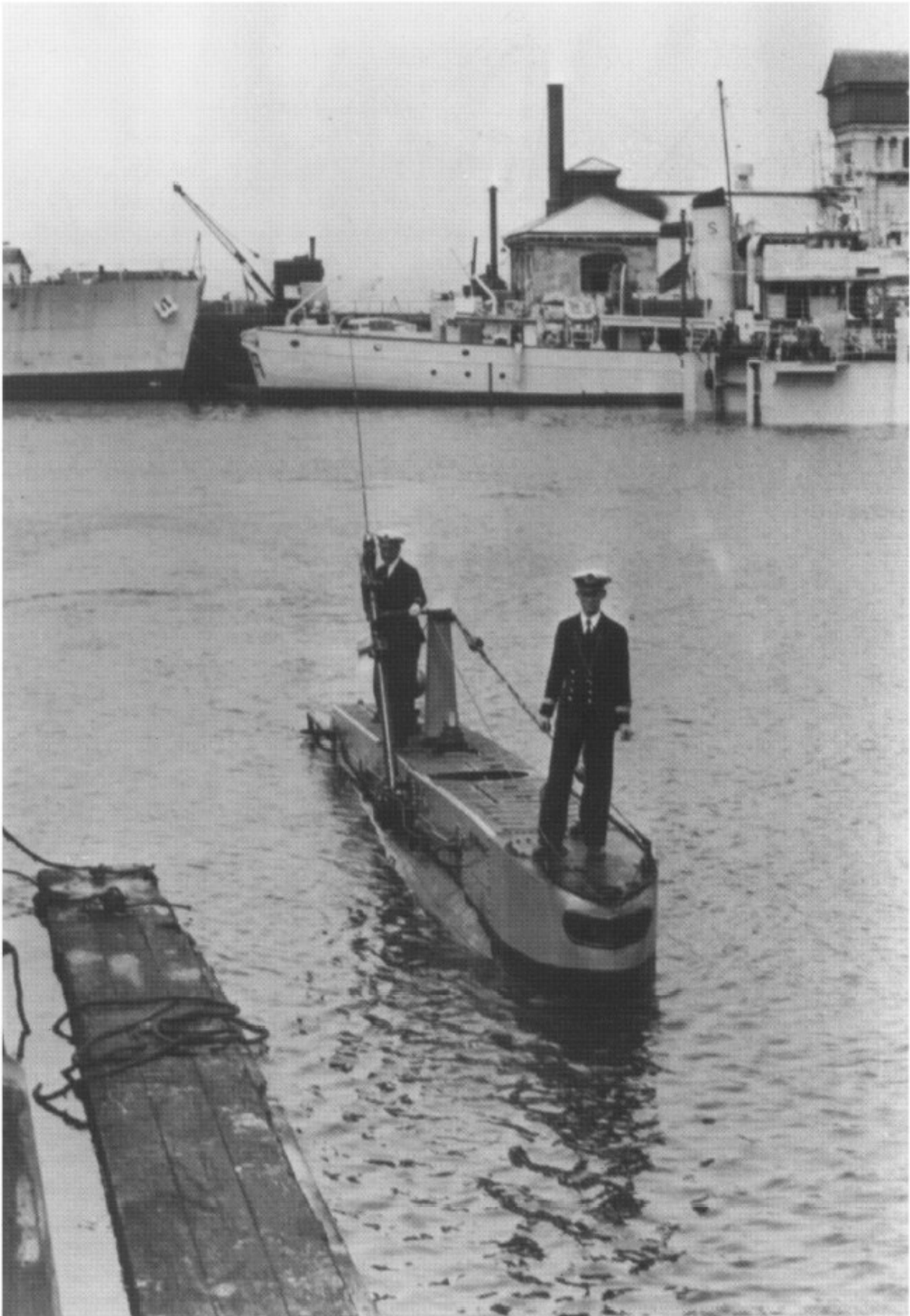
Một tàu lớp X-51 đang đến dọc theo một cầu tàu. Bức ảnh chụp cho thấy cột hút khí lớn
