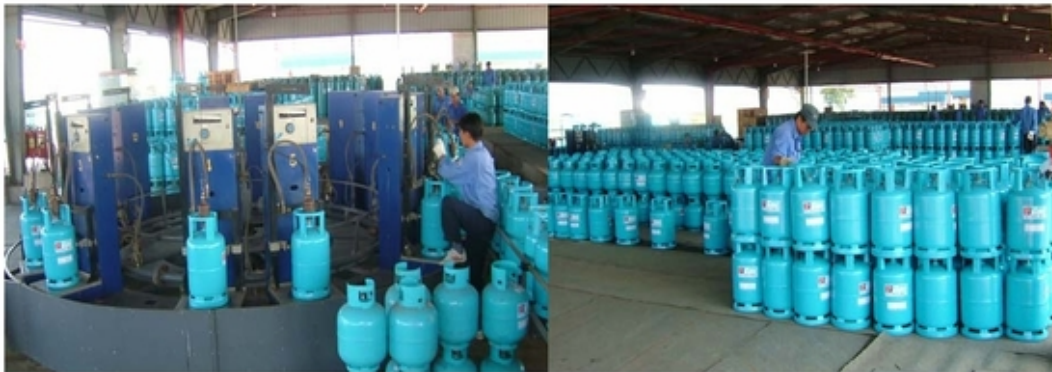
Hình 2.2.a. Hệ thống chiết nạp và kiểm tra xuất xưởng bình gas thương phẩm của Petrolimex
