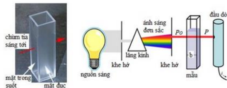
Hình 69. Nguyên tắc hoạt động của máy quang phổ kế (spectrophotometer) (phải) và cuvette chứa mẫu (trái)
