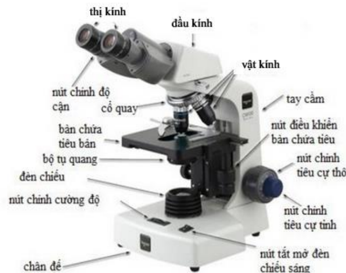
Hình 3. Cấu tạo kính hiển vi quang học nền sáng
