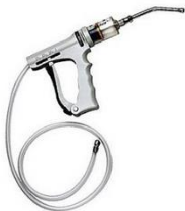
Hình 36. Bơm tiêm tự động dùng để phân phối môi trường
