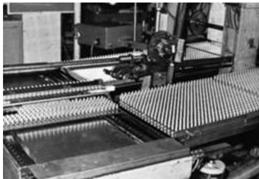
Hình 11.11. Các vỏ nang đang được sấy trong buồng sấy
