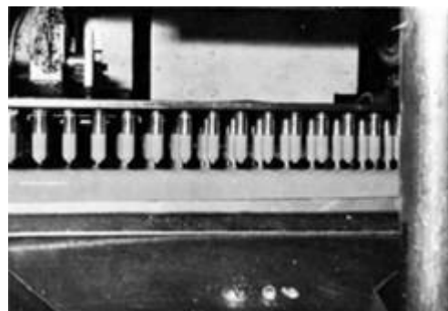
Hình 11.10. Tạo hình vỏ nang bằng cách nhúng các khuôn hình trụ bằng thép không gỉ vào dung dịch gelatin
