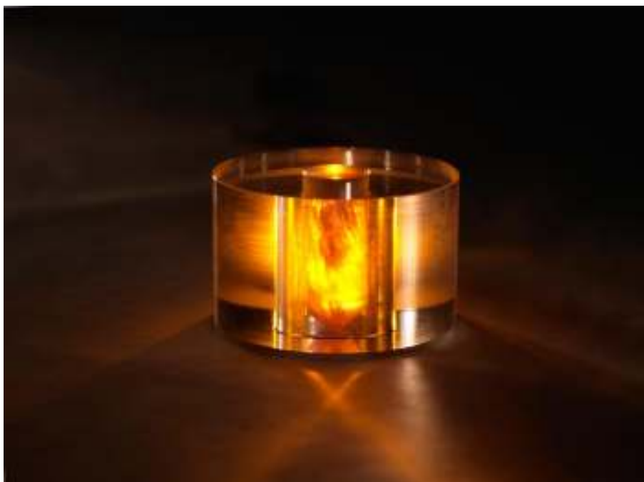
Ảnh chụp lõi maser, nổi lên với ánh sáng bom màu vàng, phát triển tại Phòng thí nghiệm Vật lý Quốc gia ở Anh. (Ảnh: NPL)
