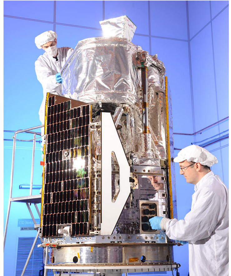
Kiểm tra phi thuyền NuSTAR trước khi kết nối nó với tên lửa Pegasus XL mang nó vào quỹ đạo. (Ảnh: VAFB/Randy Beaudoin)
