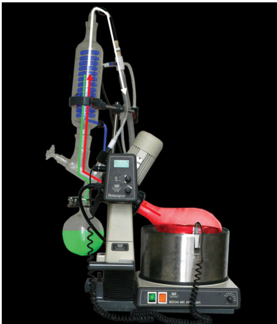
Hình 1. Từ phòng thí nghiệm đến nhà bếp. Một máy quay bay hơi, thường thấy trong phòng thí nghiệm khoa học, có thể dùng để trích xuất ra những phân tử thơm tinh tế sẽ bị hỏng mất nếu chưng cất ở nhiệt độ cao truyền thống. Chất lỏng ở trong cái buồng đang quay (màu đỏ) được nung nhẹ trong điều kiện chân không, làm cho nó bay hơi ở một nhiệt độ thấp hơn. Những cuộn ngưng tụ (màu xanh lam) làm hơi đó hóa lỏng, rồi thu gom trong cái bình thót cổ ở bên trái (màu xanh lá). (Ảnh: Dave Arnold, Cooking Issues )
