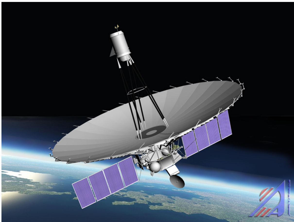
Ảnh minh họa Spektr-R, Anten 10 m đặt trên vũ trụ thuộc dự án RadioAstron. Ảnh: Lavochkin Association
