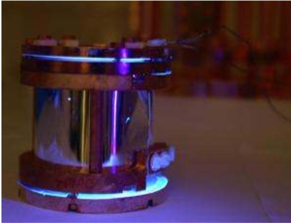
Các máy dò vật chất tối chôn sâu bên dưới dãy Gran Sasso. (Ảnh: Viện Max Planck)
