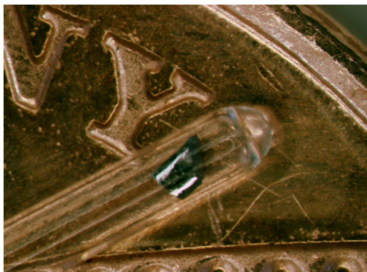
Tinh thể nhỏ màu xám này của silicon-28 đã làm giàu cao được pha tạp với các nguyên tử phospho, và chứa 10 tỉ cặp qubit spin, từng cặp một bị vướng víu đồng thời với nhau. Các chữ cái phông nền khắc trên một đồng 1 penny Anh quốc. (Ảnh: Stephanie Simmons)
