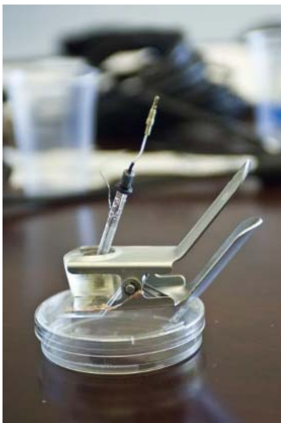
Tế bào kiểm nghiệm do đội nghiên cứu chế tạo để đo các tính chất của hệ quang hợp tự lắp ráp. (Ảnh: Patrick Gillooly, MIT)
