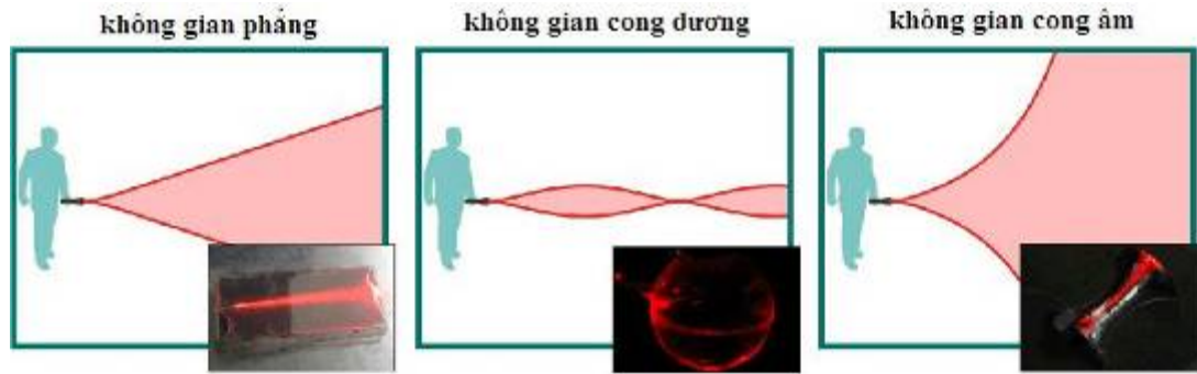
Ánh sáng laser bị bẫy lại trên hai mặt cong khác nhau (Ảnh: U Peschel et al.)
