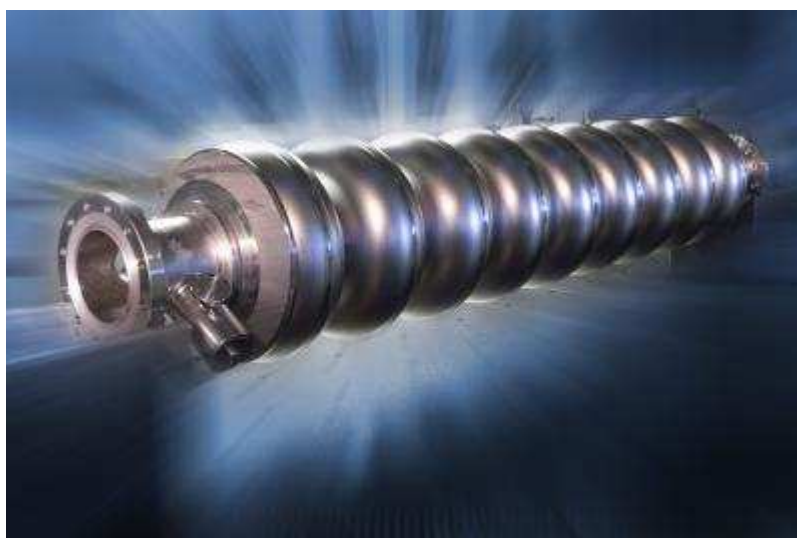
Các hộp tần số vô tuyến siêu dẫn là một công nghệ then chốt cho các máy gia tốc thế hệ tiếp theo và tương lai của vật lí hạt cơ bản. Ảnh: Fermilab.
