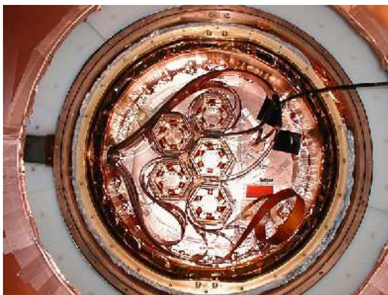
Các detector CDMS có hình lục giác, xếp trong một hộp bằng với sáu lớp phân cách để giữ cho các thiết bị đủ lạnh. Ảnh: CDMS.
