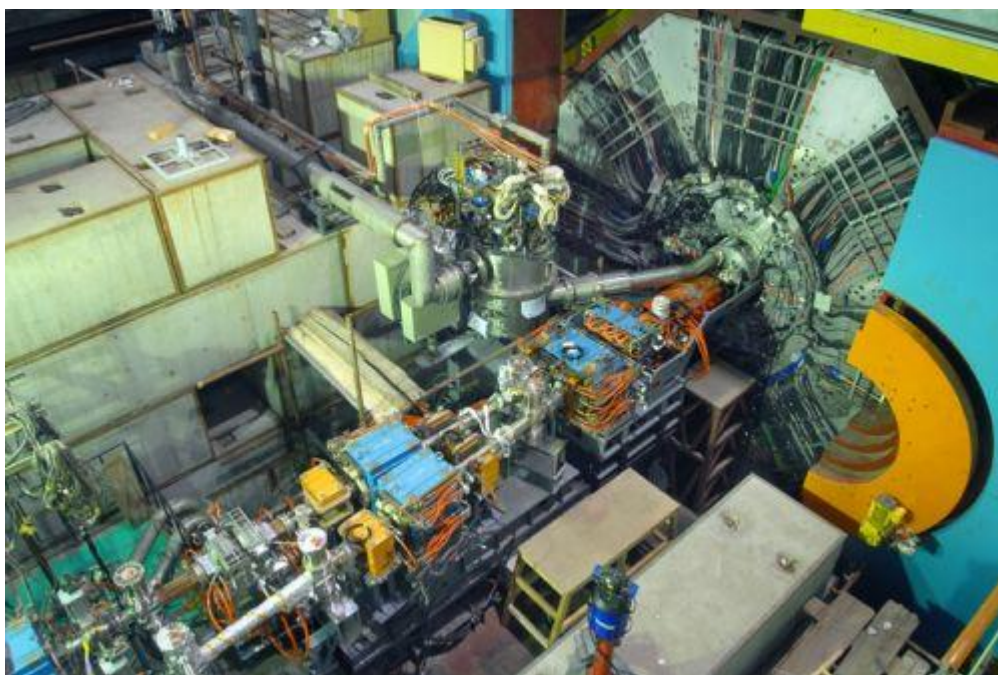
Máy dò hạt BES-II được thiết kế lại tại vùng va chạm của BEPC-II nâng cấp.
