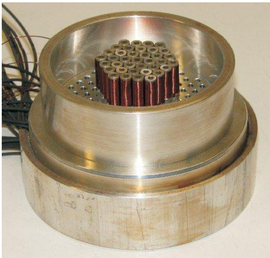
Dây cuộn dây từ tính điều khiển chiếc gương lõng từ do Denis Brousseau và các đồng sự tại trường đại học Laval chế tạo.
