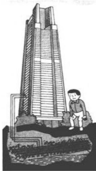
Ở nơi không có dây tiếp đất an toàn chuyên dụng, có người thường lấy ống nước máy làm dây tiếp đất an toàn. Bởi vì ống nước máy là ống kim loại chôn sâu dưới đất, thông thường mà nói cũng có thể có tác dụng tiếp đất an toàn. Nhưng phải nối vào đoạn ống nước máy gần mặt đất nhất có thể tiếp xúc tốt.
