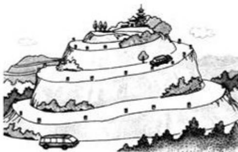
Còn có một ví dụ nữa, ở hai đầu của những chiếc cầu lớn đều có cầu dẫn rất dài, đôi khi cầu dẫn được xây theo hình xoắn ốc. Người ta làm như vậy đều với mục đích là giảm đi độ dốc của cầu.
